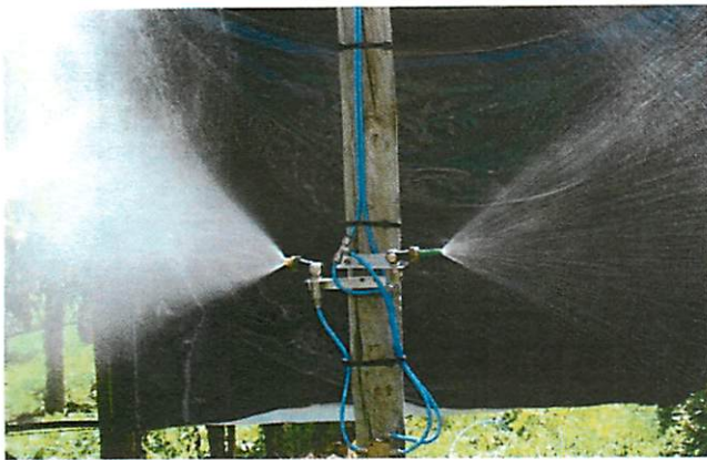
Rechts im Bild: Tropfenaufbereitung mittels Injektordüse. Links im Bild: Der hohe Feintropfenanteil ist gut zu erkennen. Ursache ist die Tropfenaufbereitung mittels Hohlkegeldüse
